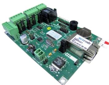
A **IPLOCK P200** é uma placa de controle de acesso desenvolvida pela Nexcode exclusivamente para automação de: **PORTAS** dotadas de fechaduras elétricas ou eletromagnéticas, **PORTÕES** e **CANCELAS**.
