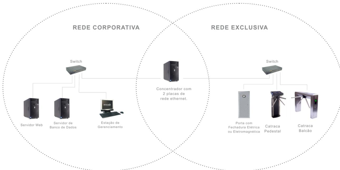
Na ilustração acima, temos 2 (duas) redes interligadas, ou seja, os dispositivos de controle (catraca, porta, etc.) em uma rede exclusiva e os demais equipamentos (Servidor Web, Servidor de Banco de Dados e Estação de Gerenciamento) na rede corporativa. O Concentrador faz a interligação das redes utilizando-se de 2 (duas) placas de rede.
