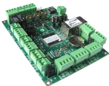
A **IPLOCK P300** é uma placa de controle de acesso desenvolvida pela Nexcode exclusivamente para automação de: **CATRACAS**, **BARREIRAS DE VIDRO** e **TORNIQUETES**.
